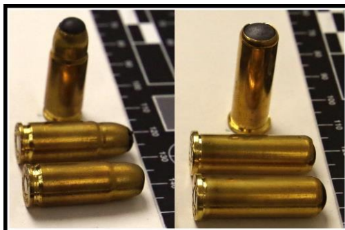
Obr. 3 – Náboje s jednotnou gumovou střelou – zleva: 9 mm LUGER RUBBER a .38 Special RUBBER
