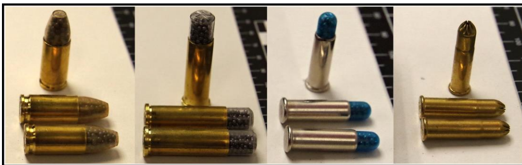
Obr. 2 – Náboje s hromadnou střelou – zleva: 9 mm LUGER, .38 SPECIAL, .22 EX LR a .22 LR Winchester X SUPER
