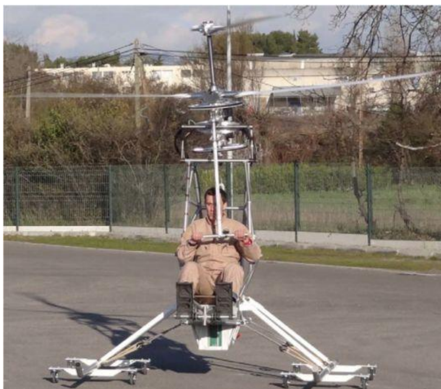
Obr.2: Pohled na elektrický vrtulník zepředu – pro změnu směru letu se natáčí celá osa vrtule
