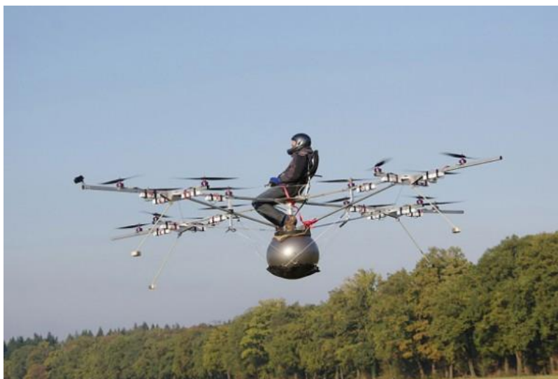
Obr.13: Šestnáctimotorový Volocopter VCI vyvinutý původně k bezpilotním zkouškám
