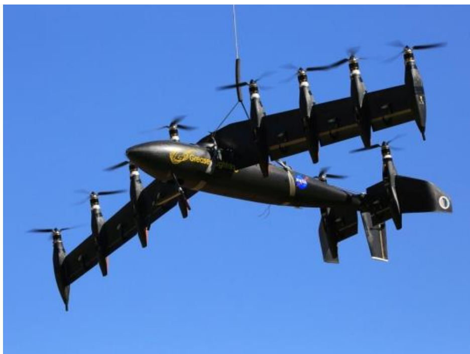
Obr.8: Zmenšený prototyp konvertoplánu GL-10 na čistě elektrický pohon
