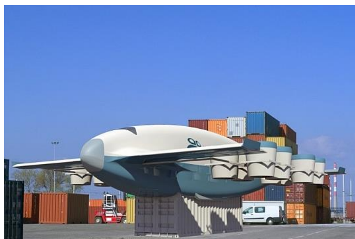
Obr.10: Nákladový prostor VV-Plane pojme standardní lodní kontejner.
