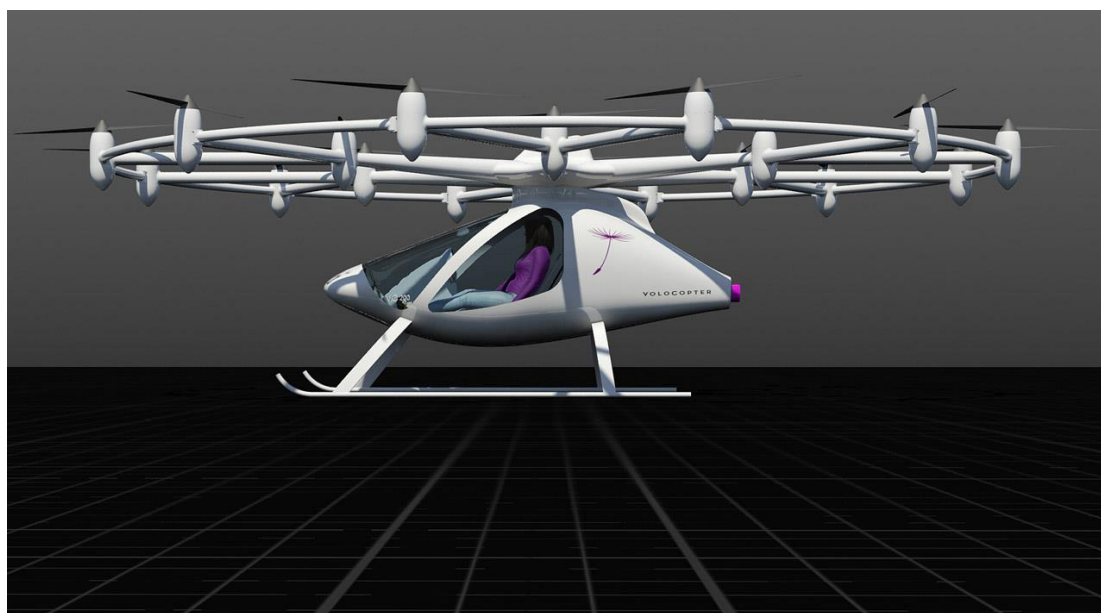
Obr.14: Jednomístná verze VC-2 s osmnácti elektrickými motory
