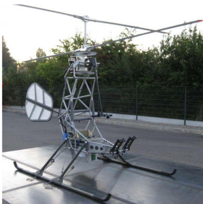
Obr.3: Elektrický vrtulník Pascala Chretieny používá dva koaxiální dvoulísté rotory
